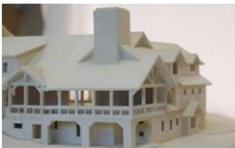
6-сурет- Zprinter 310 көмегімен басылған сәулеттік үлгі
