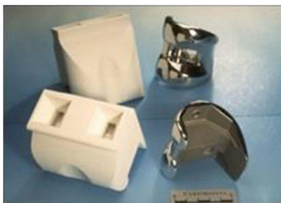
9-сурет - Енгізу коллекторын құю қабықшаларды өндіру бойынша тікелей құюды пайдалану арқылы жүргізіледі
